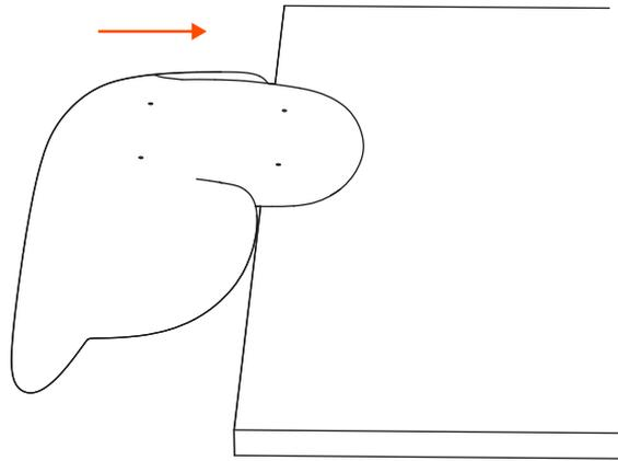
Posizionare la seduta capovolta sopra un piano di appoggio come da immagine. | Lay the shell upside-down, over a bearing surface, as shown in the picture.
