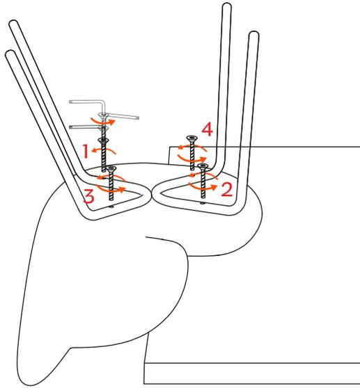
Posizionare la struttura della sedia capovolta sopra la seduta ed avvitare i due componenti con le viti fornite. | Put the chair metal base on the shell layed previously upside-down and screw the two elements with the given screws.
