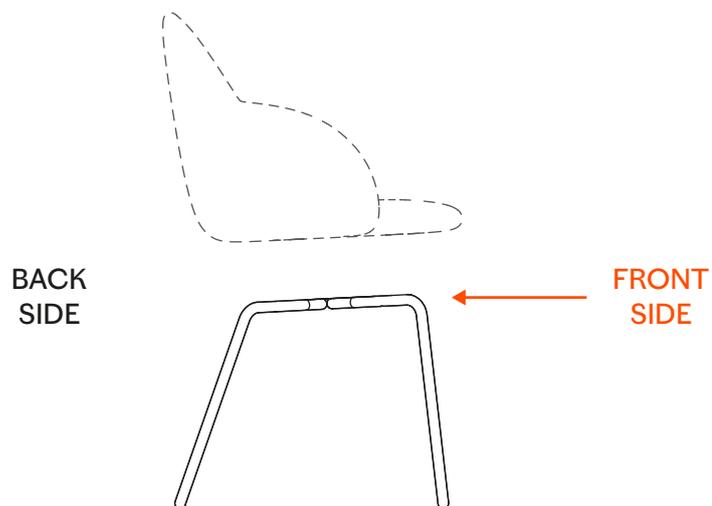
ATTENZIONE! La parte frontale della base in metallo è quella **più alta**, come da immagine. | WARNING! The front-side of the metal base is the **higher** one, as shown in the picture.
