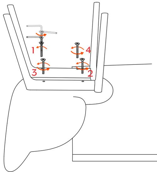
Posizionare la struttura della sedia capovolta sopra la seduta ed avvitare i due componenti con le viti fornite. | Put the chair wooden base on the shell layed previously upside-down and screw the two elements with the given screws.
