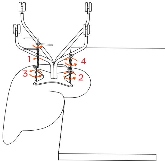
Posizionare la base con ruote capovolta sopra la seduta ed avvitare idue componenti con le viti fornite. | Put the chair swivel base on castors on the shell layed previously upside-down and screw the two elements with the given screws.
