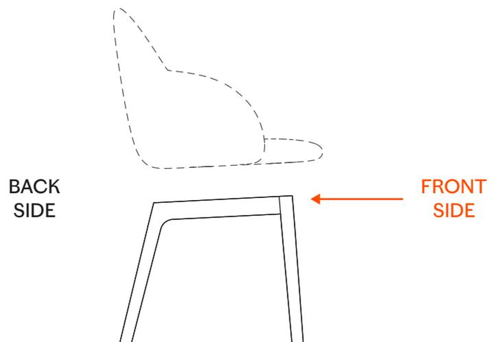
ATTENZIONE! La parte frontale della base in legno è quella **più alta**, come da immagine. | WARNING! The front-side of the wooden base is the **higher** one, as shown in the picture.
